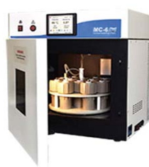
Расми 3. а) Автоклави аналитикии микромавҷӣ МС-10 ширкати Volta; б) дастгоҳи фотометрия РНЛАРНО-4 ширкати Carlcase Jena.
